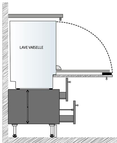
Permet de positionner votre lave-vaisselle sur un caisson bas de largeur 600 mm.
