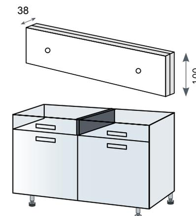
Permet une séparation centrale pour recevoir un tiroir en partie haute de caisson.
