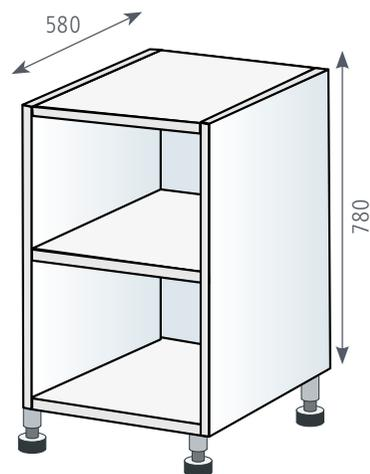
Livré avec 1 tablette, 4 pieds réglables Ht 100-130 mm. Profondeur intérieure utile 521 mm.
