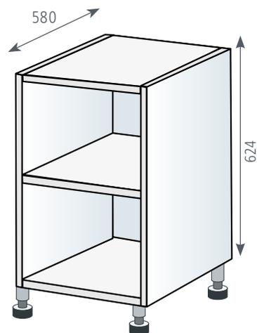
Livré avec 1 tablette, 4 pieds réglables Ht 100-130 mm. Profondeur intérieure utile de 521 mm.
