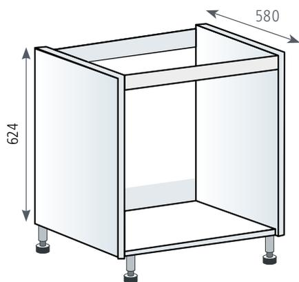
Livré avec 4 pieds réglables Ht 100-130 mm, pas de tablette. Profondeur intérieur utile de 475 mm. Traverse avant aluminium.
