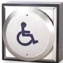
**EFF069** Bouton poussoir applique lumineuse avec symbole PMR, 130 x 130 x P 80 mm, Ø 115 mm avec contact NO / NF. Plaque avant inoxydable. Pouvoir de coupure : 3 A 125 VAC, 6 A 24 VCC .....172,27 €
