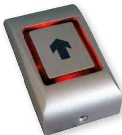
**EVI013** Bouton tactile en applique couleur gris, avec signal sonore buzzer et éclairage rouge au repos et vert lors de l'ouverture de porte, 1 contact NO/NF. Alimentation 12/24 VCC Dimensions : L 51 x H 92 x P 25 mm .....122,03 €
