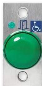
**AIP056** Bouton poussoir champignon (1 cm de saillie) sur plaque inox à encastrer, 1 contact NO/NF, Led et buzzer de signalisation avec pictogramme porte. Dimensions : 80 x 38 mm .....187,39 €
