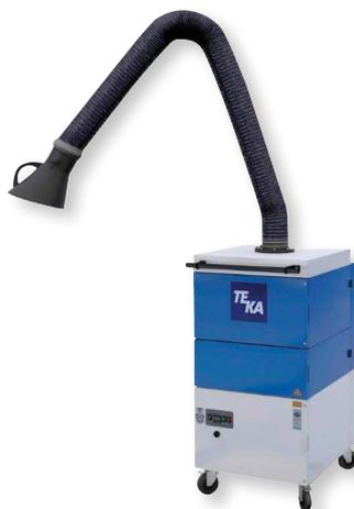
Unité mobile d'aspiration de fumée de soudage offre un degré de séparation de  $\geq 99\%$  certifié IFA. Approprié pour l'aspiration de fumées lors des travaux de soudage sur des aciers alliés « W3 ».
