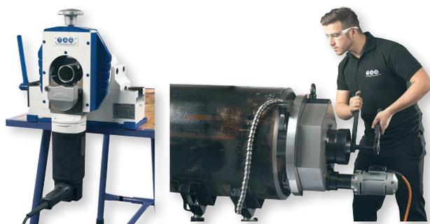
Tout type de chanfreineuse électrique pneumatique manuelle ou semie automatisée
