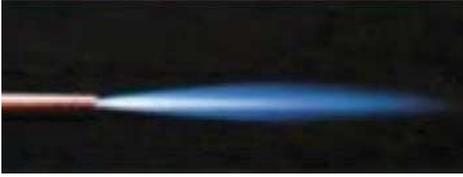
**Flamme oxydante** : excès d'oxygène, dard aminci avec sifflement, métal en fusion instable, ce qui rend la soudure brûlée et cassante.
