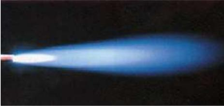
**Flamme carburante** : excès d'acétylène, auréole blanchâtre qui provoque un bouillonnement du métal en fusion, ce qui rend la soudure poreuse et cassante.
