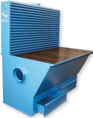
Appropriée pour l'aspiration par l'arrière et le bas, lors des travaux de meulage. 90 % des particules aspirées sont déjà séparées par la face arrière et peuvent être éliminées simplement par le tiroir collecteur de poussière.
